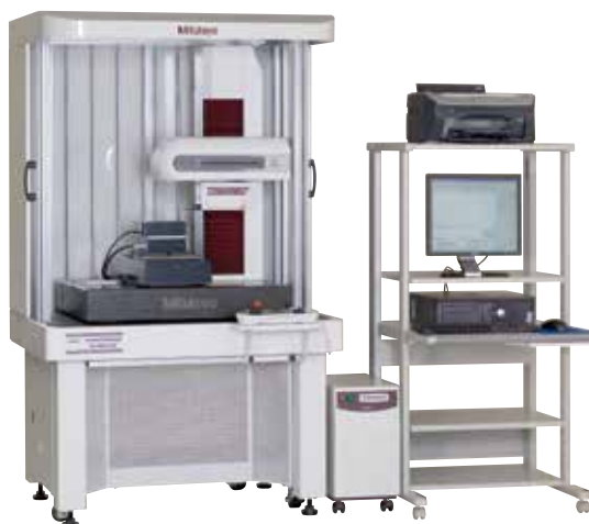
Formtracer Extreme CS-5000CNC/CS-H5000CNC (사진은 CS-H5000CNC, 3D 오토 레벨링 테이블 장착 소형 01축, Y축 테이블 장착 사양)
