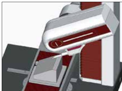
X축 방향의 경사 측정
