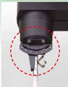
검출기(수직 방향에 있을 경우)에는 Z 축 방향에서의 충돌을 방지하기 위해 충돌 감지 기능이 추가되어 있습니다. 또한, 검출기 범위를 초과할 경우, 측정 장치를 정지시키는 우발적인 충돌 방지 기능이 추가되어 있습니다. 액시덴탈 터치가 감지될 경우, 전용 해석 소프트웨어(ROUNDPAK)가 오류를 감지하고 해당 장치를 자동으로 정지시킵니다.
