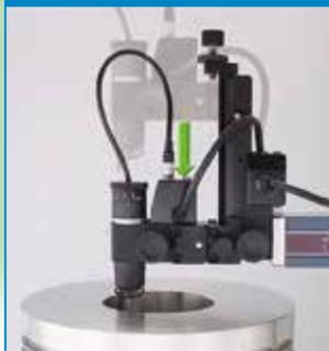
검출기 홀더 부분에 슬라이드 기구를 탑재. 기존의 표준 암에서는 측정이 어려웠던 깊은 홀 측정물 등을 원터치로 간단히 측정 가능 합니다.
