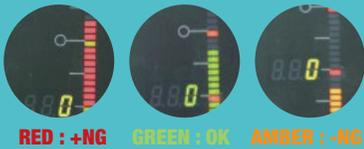
KG-21은 생산 현장 또는 측정실에서 편리하게 사용할 수 있도록 설계 제작된 컬럼형 3색 LED 공기·전기 마이크로미터입니다.
