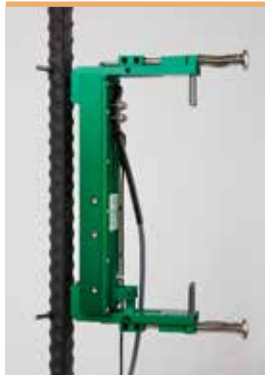
모델 3543-0400-200T-ST, 4인치 표점 거리 및 +2인치 측정 범위
