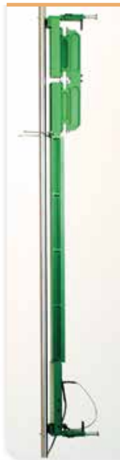
시험 중 최대 15°까지 비틀림을 견딜 수 있는 스페셜 모델 3543
